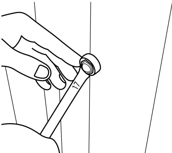
Schieben Sie die Unterlegscheibe und drehen Sie die Mutter wieder auf die Stange und ziehen Sie beide Muttern mit einem 17 mm Gabelschlüssel leicht fest.
