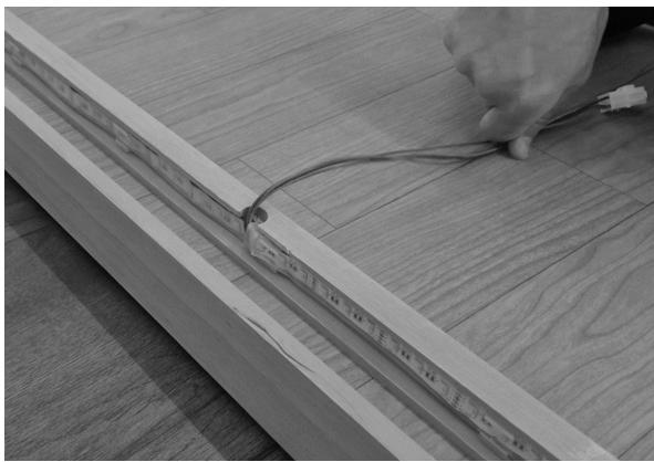
Das Ende mit der Steckverbindung muss in die Aussparung der Leiste geführt werden.
