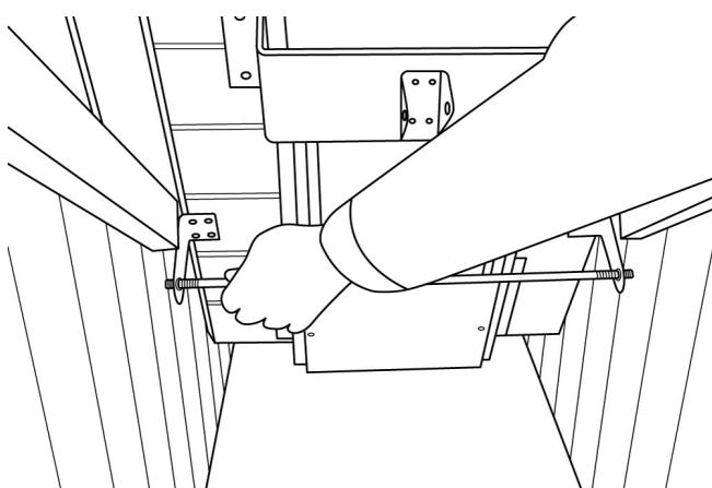
Die Stange muss auch durch die Löcher der Winkel (1-8) und des gegenüberliegenden Rahmens geführt werden.
