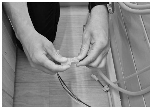
Verbinden Sie alle Steckverbindungen an der Rückseite der Liege miteinander.
