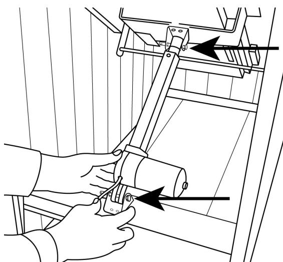
Montieren Sie den Motor (**1-10**) mittels der Bolzen an die Motorhalterung (**1-7**) und befestigen Sie die untere Montagehalterung (**1-15**). Halten Sie die Montagehalterung mittig an den Balken (**1-4**) und schrauben Sie die vorderen beiden Schrauben (**2 Stück 40 mm**) an.
