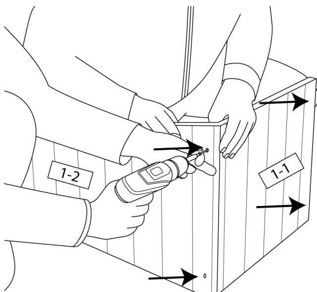
Schrauben Sie das Brett (1-1) an die Vorderseite des Rahmens (1-2) und (1-3) mittels **4 Stück 40 mm** Schrauben. Die Nut-Feder Rillen müssen dabei vertikal verlaufen.
