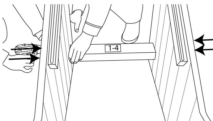
Positionieren Sie nun den Balken (1-4) auf den Hilfssprossen zwischen den Rahmen (1-2) und (1-3) so, dass die Anzeichnung für die Motorhalterung oben ist. Schrauben Sie ihn von außen mit **4 Stück 60 mm** Schrauben an.
