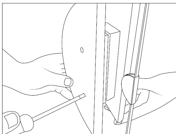
Montieren Sie den Türgriff mit **2 Stück 50 mm metrischen** Schrauben. Dazu stecken Sie eine Schraube durch das obere Loch des Innengriffs und das obere Loch in der Glastür. Schrauben Sie jetzt den Außengriff an. Verfahren Sie dementsprechend mit der zweiten Schraube.
