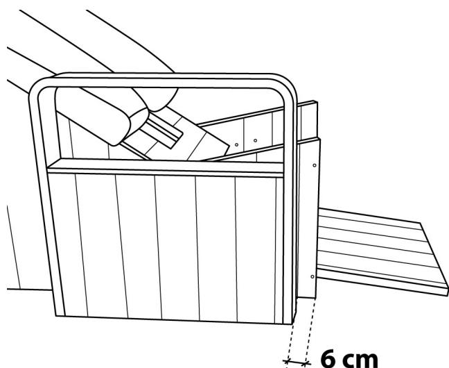
Positionieren Sie beide Armlehnen (**1-11 und 1-12**) seitlich der Liegen, sodass der Abstand von der Armlehne zur Vorderkante des Rahmens etwa 6 cm beträgt. Verwenden Sie das Transportsicherungsbrettchen als Abstandshalter.
