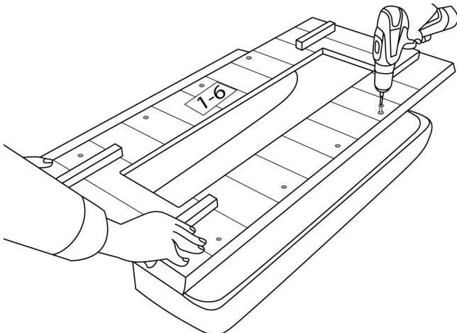
Legen Sie das Rückenstrahlerbrett (1-6) mit den vier Führungsschienen nach oben auf die beiden Rückenpolster (1-5), Rückseite nach oben. Die Innenseite der Aussparung sowie die schräge Oberseite des Rückenstrahlerbretts müssen mit den Polstern plan abschließen.
