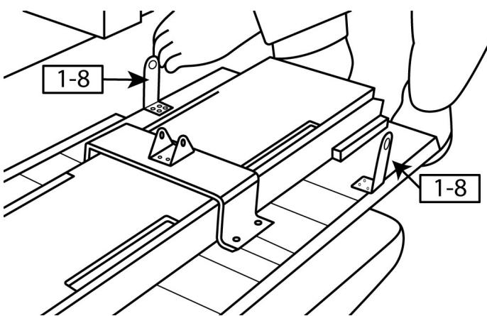
Schrauben Sie die beiden Winkel (1-8) mit je **4 Stück 25 mm** Schrauben fest.
