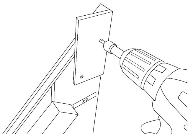
Zu Beginn entfernen Sie bitte die Transportsicherungsbrettchen am spitzen Ende der seitlichen Rahmen (1-2) und (1-3). Danach richten Sie die beiden Rahmenbretter (1-2) und (1-3) parallel stehend und mit den Leisten nach innen zeigend aus.
