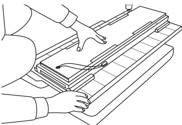
Befestigen Sie einen Infrarotstrahler mit **4 Stück 60 mm Schrauben** am Rückenstrahlerbrett (1-6) zwischen den Führungsschienen, sodass der Strahler oben und unten mit diesen plan abschließt.
