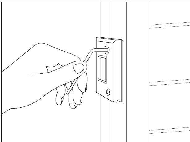
Ziehen Sie die Schrauben der Scharniere der Glastür mit Hilfe eines 4 mm Sechskantschlüssels (Inbus) nach.
