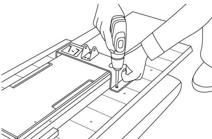
Legen Sie nun die Motorhalterung (1-7) auf den Infrarotstrahler. Die Löcher zur Positionierung sind bereits vorgebohrt. Schrauben Sie diese mit **4 Stück 30 mm Schrauben** fest.
