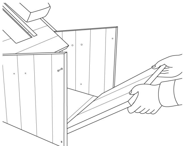
Schrauben Sie die oberen beiden Schrauben des vorderen Bretts (**1-1**) wieder ab und drehen Sie es nach unten.
