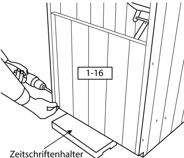
Jetzt montieren Sie die Rückwand (**1-16**) an die hintere Seite des Rahmens.
