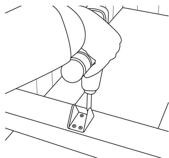
Anschließend entfernen Sie den Motor von der Montagehalterung und schrauben die hinteren beiden Schrauben (**2 Stück 40 mm**) fest.
