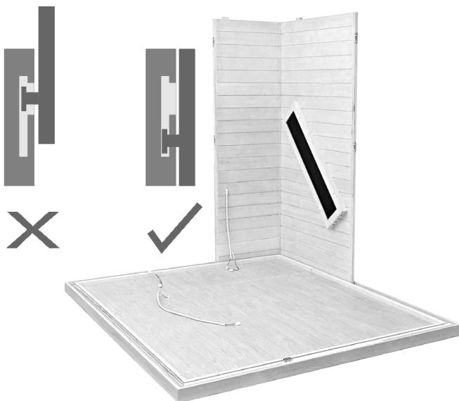
Stellen Sie die Seitenwand-Hälfte mit den zwei Kabelsträngen auf die Bodenplatte in die dafür vorgesehene Aussparung.
