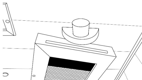
Die Halterung mit dem Glasschälchen sollte mittig über einem Infrarotstrahler montiert werden (**2 Stück 40 mm** Schrauben). Die aufsteigende Hitze erwärmt das Aromaschälchen, wodurch sich die Essenzen im Raum verteilen können. Der vertikale Abstand zwischen dem Strahlerrahmen und der Halterung muss mindestens 2 cm betragen. Wir empfehlen, die Löcher vorzubohren, um Risse zu vermeiden.
