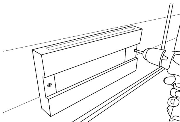
Die Zeitschriftenhalterung wird mit **2 Stück 40 mm** Schrauben an die Kabinenwand montiert. Wir empfehlen, die Löcher vorzubohren, um Risse zu vermeiden.
