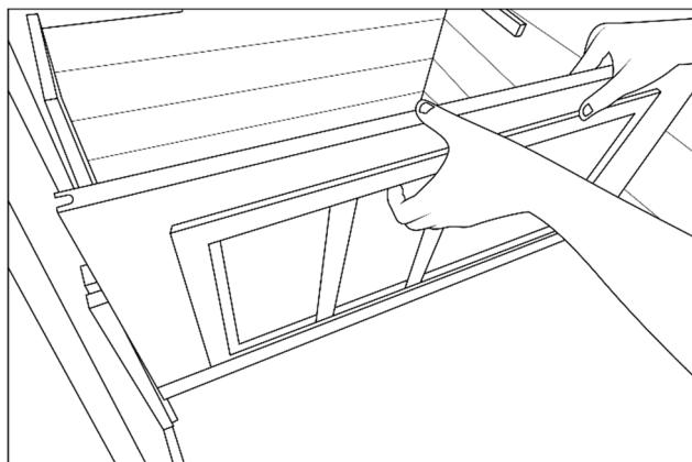
Schieben Sie den Wadenstrahler in die seitlichen Führungsschienen. Der schwarze Flächenstrahler muss dabei, wie abgebildet, in Ihre Richtung zeigen. Achten Sie darauf, dass Sie keine Kabel einklemmen. Schließen Sie jetzt die **beiden Steckverbindungen** an.
