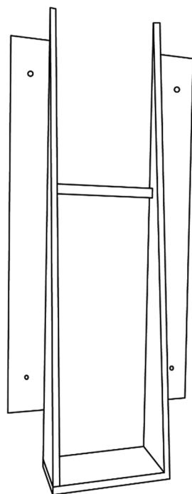
Halten Sie den Adapter für den Rückenstrahler mit den Spitzen nach oben in die Aussparung für den Infrarotstrahler an die Rückwand. Schrauben Sie den Adapter mit **je 4 Stück 30 mm** Schrauben an die Rückwand an.
