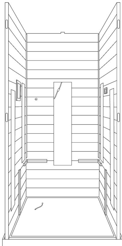
Platzieren Sie die Seitenwände im rechten Winkel zur Rückwand auf den Boden so, dass sie in die Aussparung passen. Heben Sie die Seitenwände an, bis die Metallbolzen in der Höhe der Löcher der Einhängevorrichtung sind. Drücken Sie die Seitenwand an die Rückwand und achten Sie darauf, dass die Metallbolzen in die Einhängevorrichtungen einrasten. Die Seitenwände und die Rückwand müssen oben plan abschließen.
