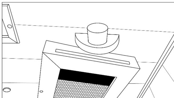
Die Halterung mit dem Glasschälchen sollte mittig über einem Tiefenwärmestrahler an der Seite montiert werden (**2 Stück 40 mm** Schrauben). Der Abstand zwischen dem Strahlerrahmen und der Halterung muss mindestens 2 cm betragen. Wir empfehlen, die Löcher mit einem 2 - 3 mm Holzbohrer vorzubohren, um Risse zu vermeiden.
