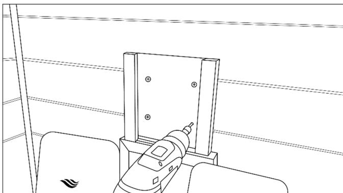
Positionieren Sie das Brett der Kopfstütze mittig oberhalb des Rückenstrahlers zwischen den flexiblen ergonomischen Rückenlehnen und schrauben Sie diese mit den mitgelieferten Schrauben (**4 Stück 30 mm**) an die Rückwand.
