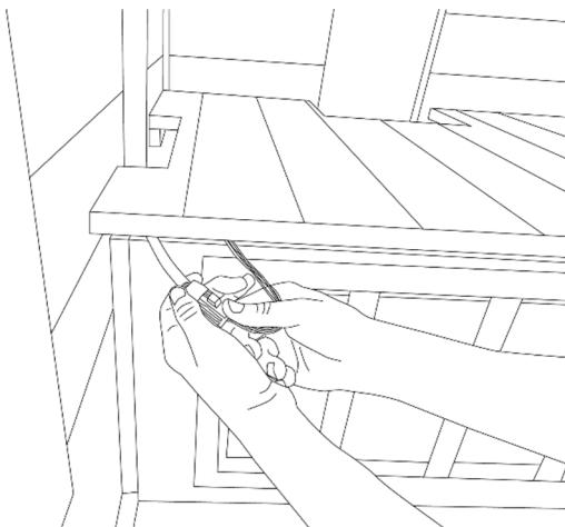
Verbinden Sie jetzt die Steckverbindung von der Farblichtleiste mit der vierpoligen Steckverbindung unterhalb der Sitzbank und verstecken Sie diese.
