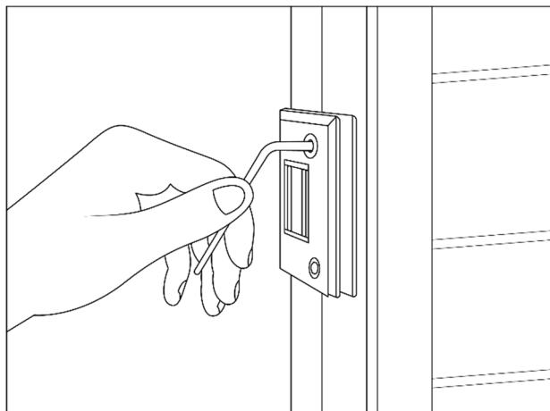
Ziehen Sie die Schrauben der Scharniere der Glastür mit Hilfe eines 4 mm Sechskantschlüssels (Inbus) nach. Gegebenenfalls können Sie die Glastür noch nachjustieren, indem Sie alle Schrauben ein wenig lockern und, am besten zu zweit, die Glastür einrichten.
