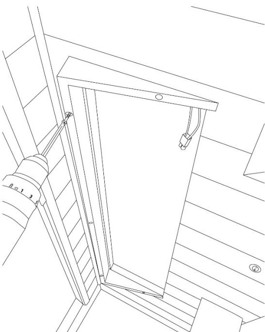
Schrauben Sie nun den Adapter mit **2 Stück 30 mm** Schrauben an der spitzen Seite und mit **3 Stück 60 mm** an der breiten Seite an.
