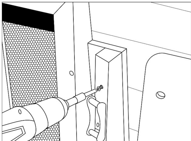
Schrauben Sie die Holzstege mit den Halterungen für die flexiblen Rückenlehnen direkt **auf** den Adapter an, so dass sie mit ihnen oben und seitlich plan abschließen (**je 3 Stück 50 mm Schrauben**).
