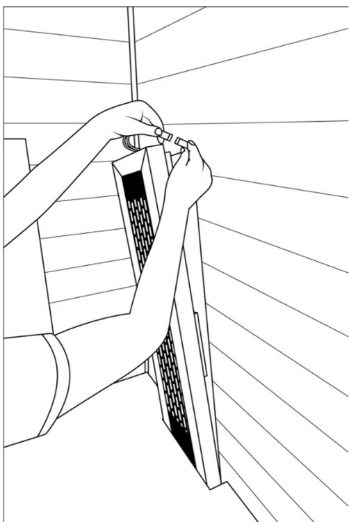
Halten Sie die Infrarotstrahler in die Aussparungen der linken und rechten Seitenwand und verbinden Sie die Steckverbindungen miteinander.
