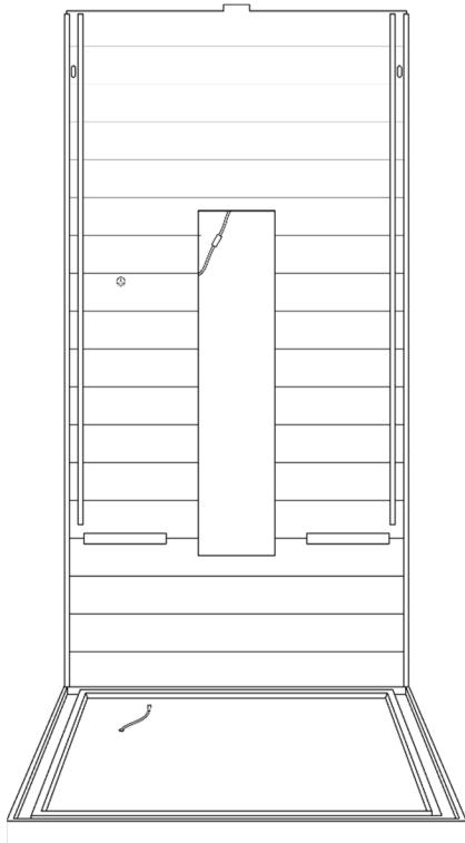
Stellen Sie die Rückwand mit der Aussparung nach innen auf die Bodenplatte in die dafür vorgesehene Aussparung. Dabei sollte die Rückwand seitlich mit den Leisten der Bodenplatte abschließen.
