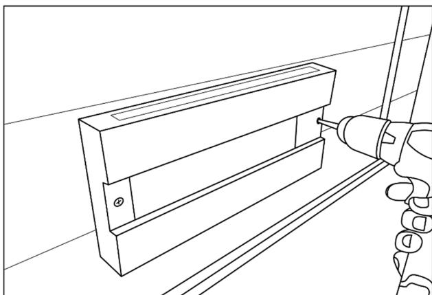
Die Zeitschriftenhalterung wird mit **2 Stück 40 mm** Schrauben an die Kabinenwand montiert. Wir empfehlen, die Löcher mit einem 2 - 3 mm Holzbohrer vorzubohren, um Risse zu vermeiden.
