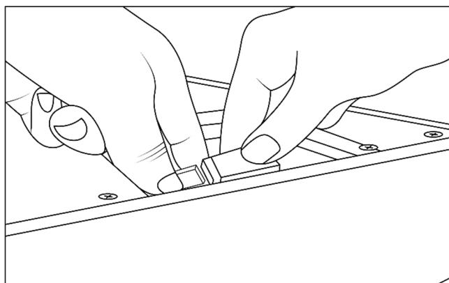
In den Wartungsschächten an der Oberseite der Infrarotkabine befinden sich die elektrischen Anschlüsse.
