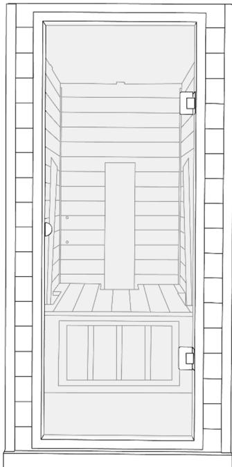
Heben Sie jetzt die Frontwand auf die Bodenplatte. Am einfachsten geht das zu zweit.
