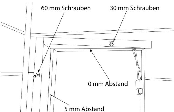
Halten Sie den Adapter mit der breiten Seite Richtung Glastür so an, dass dieser oben und unten plan abschließt und bei der breiten Seite innen an der angezeichneten Linie (mit dem 5 mm Abstand zur Aussparung) anliegt.
