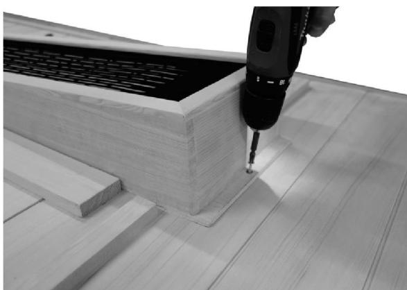
Serrez la vis de fixation (3 x 16 mm) de la partie inférieure du projecteur.
