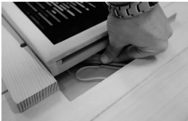
Cachez les connecteurs enfichables et les câbles derrière le projecteur. Glissez le projecteur complètement vers le haut en faisant attention à ce que les connecteurs enfichables et les câbles restent derrière et ne sont pas coincés.
