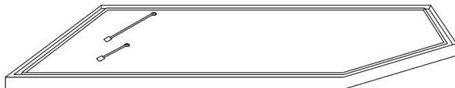
Kontrollieren Sie die Unterseite auf etwaige Fremdkörper und entfernen Sie diese, bevor Sie die Bodenplatte auf den gewünschten Standort legen. Wir empfehlen, bei Bedarf in regelmäßigen Abständen Filzgleiter an der Unterseite anzubringen. Achten Sie bereits jetzt auf die Ausrichtung der Bodenplatte. Dort, wo das Kabel aus dem Boden kommt, befindet sich in Zukunft das Kopfteil der Liege bzw. der Sitzplatz.
