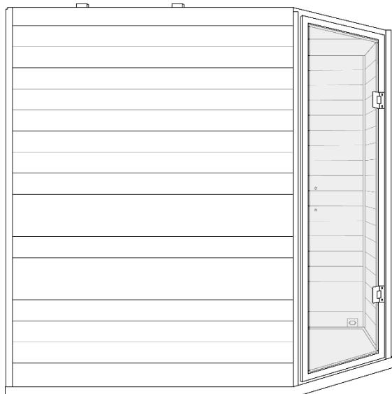
Heben Sie nun die Wand mit der Glastür auf die Bodenplatte und verbinden Sie diese mit der linken Seitenwand. Beachten Sie hier bereits auch den Türanschlag und wenden Sie bei Bedarf die Wand mit der Glastür.
