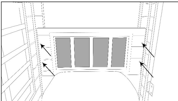
Positionieren Sie den Fußwärmestrahler in gewünschter Höhe waagerecht und mittig vor dem Fenster der Frontwand, sodass der Stecker in die schwarze Steckdose in der Frontwand gesteckt werden kann. Schrauben Sie den Fußwärmestrahler mit **4 Stück 50mm** Schrauben an die Frontwand und stecken Sie den Stecker ein.
