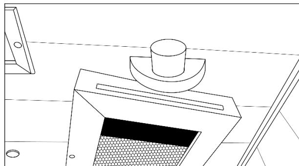
Die Halterung mit dem Glasschälchen sollte mittig über einem Infrarotstrahler montiert werden (**2 Stück 40 mm** Schrauben). Dafür bieten sich insbesondere der Frontstrahler (Relax 1) oder einer der Seitenstrahler (Relax 1 Visio) an. Die aufsteigende Wärme erwärmt das Aromaschälchen, wodurch sich die Essenzen im Raum verteilen können. Der Abstand zwischen dem Strahlerrahmen und der Halterung muss mindestens 2 cm betragen. Wir empfehlen, die Löcher vorzubohren, um Risse zu vermeiden.
