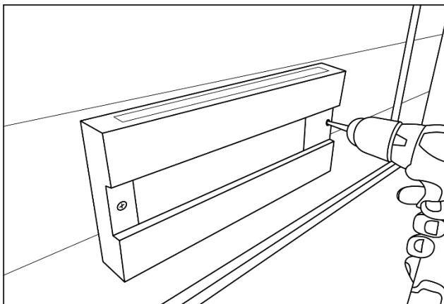
Die Zeitschriftenhalterung wird mit **2 Stück 40 mm** Schrauben an die Kabinenwand montiert, vorzugsweise an die Seitenwand-Hälfte gegenüber der Glastür. Wir empfehlen, die Löcher vorzubohren, um Risse zu vermeiden.
