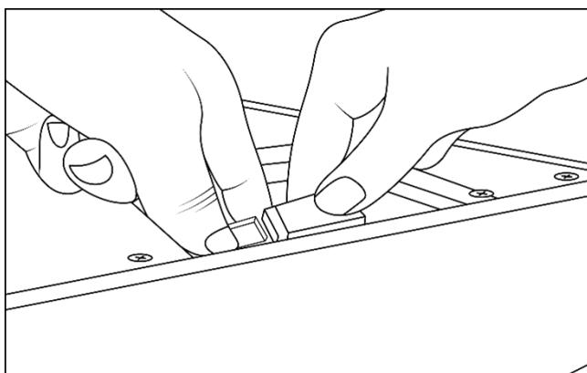
An der Oberseite der Infrarotkabine in den kleinen Schächten befinden sich die elektrischen Anschlüsse.
