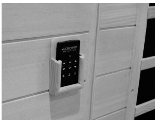
Vous pouvez monter le support de la télécommande à n'importe quel endroit facilement accessible à l'aide de ruban adhésif double face ou des vis fournies (**2 de 30 mm**). Veuillez vous assurer que l'emplacement de montage ne se trouve pas directement au-dessus d'un rayonneur infrarouge, car la chaleur croissante pourrait endommager la télécommande.
