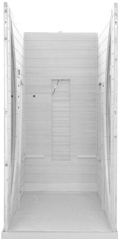
Placez les parois latérales sur le sol perpendiculairement à la paroi arrière de manière à ce qu'ils s'insèrent dans la découpe. Pour ce faire, soulevez un mur jusqu'à ce que les boulons métalliques soient au niveau des trous du dispositif d'accrochage. Appuyez la paroi latérale contre la paroi arrière et assurez-vous que les boulons métalliques s'enclenchent dans les dispositifs d'accrochage. Les parois latérales et la paroi arrière doivent se terminer bien à plat en haut.
