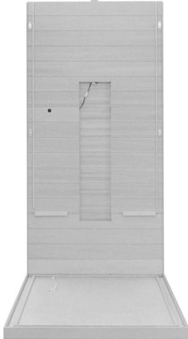
Placez la paroi arrière avec la découpe vers l'intérieur sur la plaque inférieure dans la découpe prévue. Pour ce faire, la paroi arrière doit s'aligner latéralement avec les moulures de la plaque inférieure.
