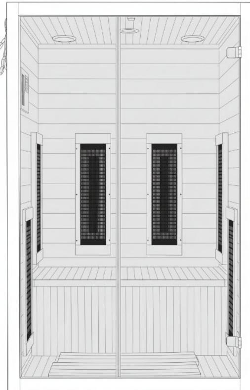
Stellen Sie sicher, dass alle Anschlüsse nach außen gerichtet sind. Heben Sie anschließend das Dachelement auf die Infrarotkabine.
