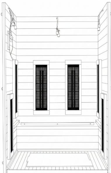
Platzieren Sie die rechte Seitenwand rechtwinkelig zu der Rückwand. Schließen Sie hier ebenfalls die Verschlüsse.
