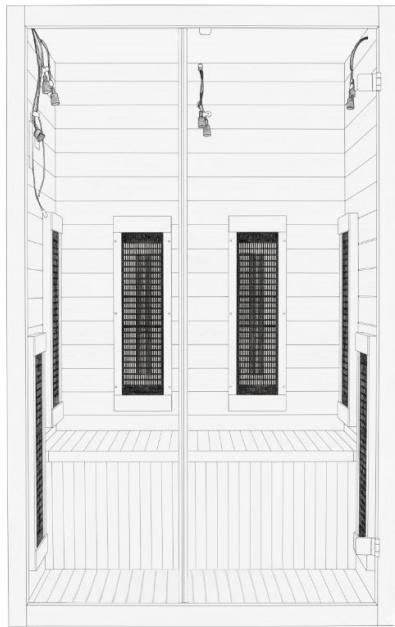
Platzieren Sie nun die Frontwand vor dem Infrarotkabinenboden, sodass die Tür nach außen aufgeht und verbinden Sie die Schnappverschlüsse.
