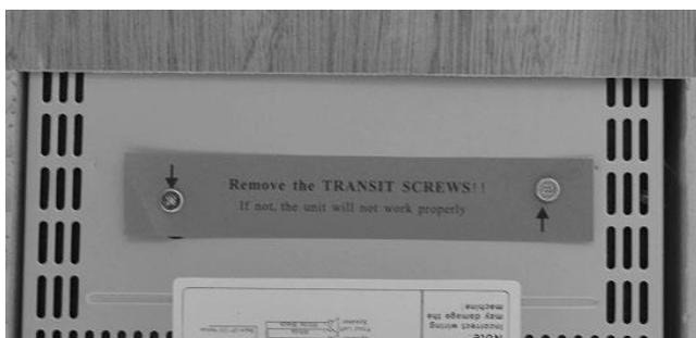
Après avoir connecté tous les connecteurs, retirez les deux vis de transport situées sur la partie supérieure du lecteur de CD, sinon le CD ne pourra pas être inséré correctement.
