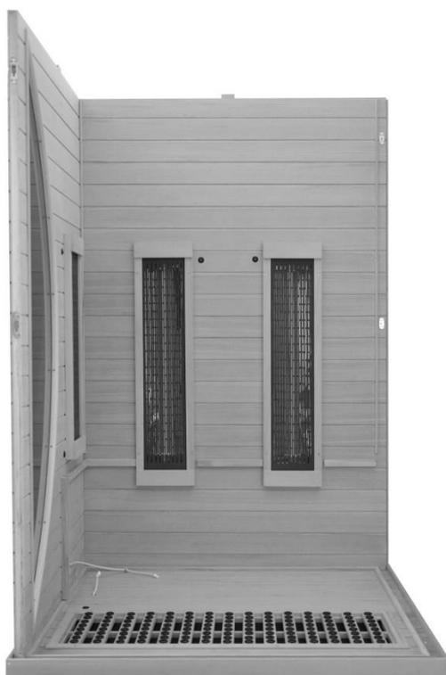
Placez la paroi latérale gauche sur le sol, perpendiculairement à la paroi arrière, de manière à ce que les encoches s'adaptent. Soulevez les panneaux latéraux jusqu'à ce que les boulons métalliques soient à la hauteur des trous du dispositif d'accrochage. Poussez la paroi latérale contre la paroi arrière en veillant à ce que les boulons métalliques s'enclenchent dans les dispositifs d'accrochage. La paroi latérale et la paroi arrière doivent être à niveau en haut.
