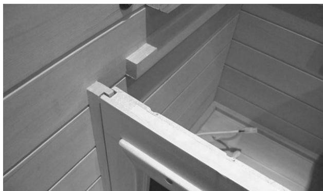
Insérez l'élément chauffant pour mollets dans les rails de guidage latéraux. L'émetteur doit être dirigé vers vous, comme illustré. Veillez à ne pas coincer de câbles. Branchez maintenant les deux connecteurs.
