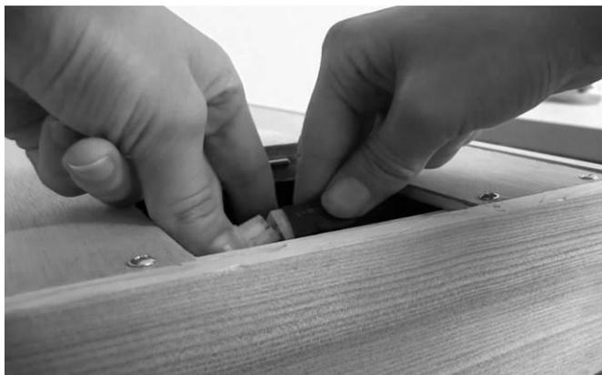
Les raccordements électriques se trouvent sur le dessus de la cabine infrarouge.
