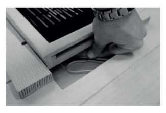
Cachez les connecteurs enfichables et les câbles derrière le projecteur. Glissez le projecteur complètement vers le haut en faisant attention à ce que les connecteurs enfichables et les câbles restent derrière et ne sont pas coincés.
