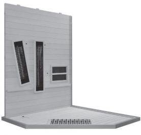
Placez un panneau arrière avec les projecteurs infrarouges vers l'intérieur dans le renfoncement prévu à cet effet dans l'embase.
