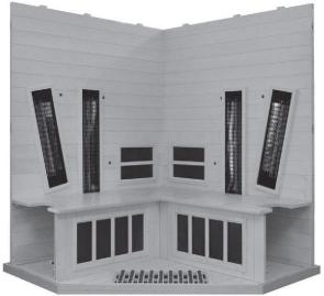
Posez les deux bancs sur les projecteurs thermiques pour mollets et les plinthes des panneaux. Le petit banc est à droite.
