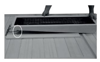
Commencez par monter les projecteurs dorsaux sur les panneaux latéraux. Pour cela, posez le panneau latéral sur le sol ou sur une surface plane et stable. Placez le projecteur dorsal entre les deux rails de guidage. Les deux tenons doivent se glisser dans les renfoncements prévus (en ovale dans l'illustration) des rails de guidage.
