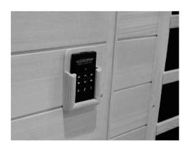
Avec un ruban adhésif double-face ou les vis livrées, montez le support de la télécommande où vous voulez, à un endroit facile d'accès. Veillez à ne pas monter le support au-dessus d'un projecteur infrarouge, la chaleur montante risquerait d'endommager la télécommande.
